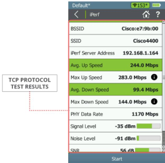
Примечание 7. Беспроводной тестер AirCheck G2 может измерять максимальную скорость до 250 Мбит/с. Если рядом с результатами проверки максимальной скорости отображается значок «i», оборудование беспроводного тестера AirCheck G2 может ограничивать максимальную скорость измерения. Это не ошибка, это просто означает, что ваша максимальная скорость выше, чем скорость, которую может измерить AirCheck G2.
