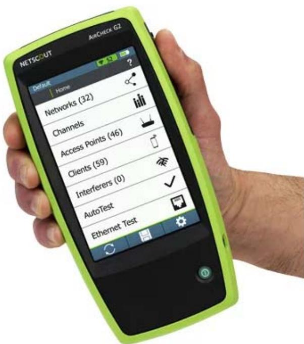
В этом документе описывается, как проводить тест производительности iPerf с помощью тестера AirCheck™ G2.
